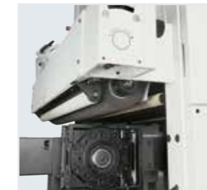
Oszillierendes Satinieraggregat und Strukturieraggregat am Auslauf für einen hochwertigen Endschliff.
