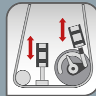
pneumatische Ein- und Ausschaltung des Kombiaggregats
