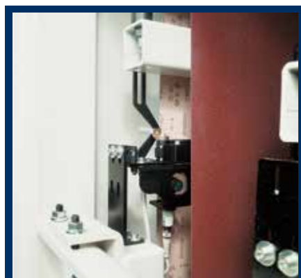
Oszillation der Schleifbänder mit elektronischer Fotozelle für eine längere Lebensdauer des Bandes.
