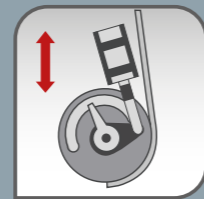
pneumatische Ein- und Ausschaltung der Walzen
