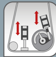
pneumatische Ein- und Ausschaltung des Kombiaggregats
