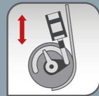
pneumatische Ein- und Ausschaltung der Walzen
