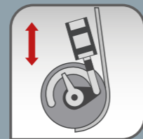
pneumatische Ein- und Ausschaltung der Walzen
