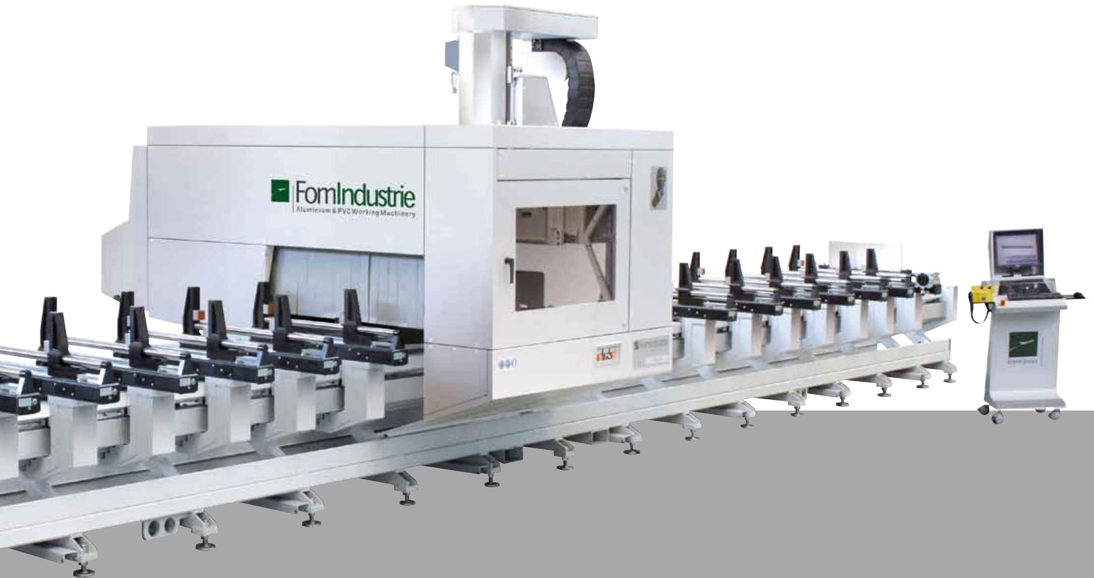
In foto: AXEL 100 con 6 morse supplementari (optional) / In the photo: AXEL 100 with 6 additional vices (optional) / Sur la photo: AXEL 100 avec 6 étaux supplémentaires (en option) Auf dem Foto: AXEL 100 con 6 mordazas suplementarias (opcional) / En la foto: AXEL 100 mit 6 zusätzlichen Spannvorrichtungen (gegen Mehrpreis)
