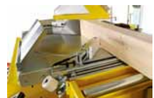
Material-Andrückrollen sorgen für optimale Positionierung des Holzes
