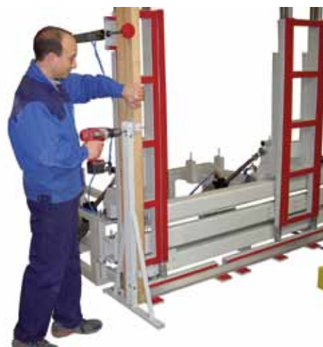
Endmontage des Montage-Kipptisch für Hebeschiebetüren in Brackenheim.
