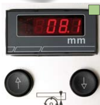
LED-Anzeige für die Spanabnahme, Drucktaster für elek. Tischverstellung
