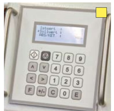
Positioniersteuerung mit direkter Maßeingabe für die Hobelhöhe
