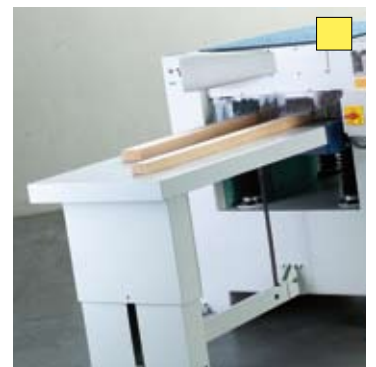
Dickentischverlängerung mit automatischer Höhenverstellung
