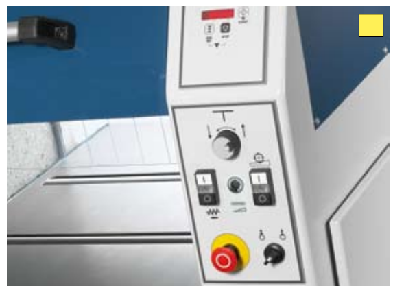
Schalterplatte für den stufenlosen Vorschub
