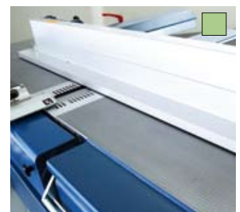
Eloxiertes Abrichtanschlaglineal mit schwenkbarem Hilfsanschlag
