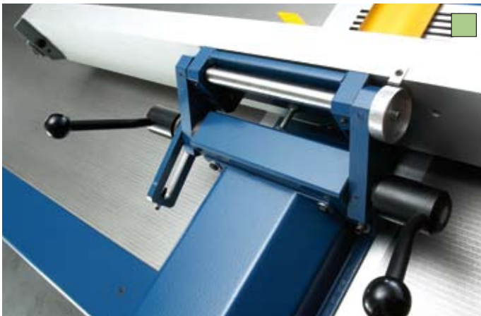
Abrichtanschlag schrägstellbar bis 45°
