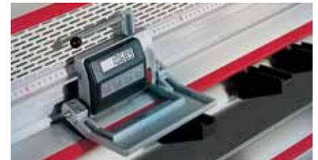
Digitales-Mess-System DMS für beide Achsen (serienmässig). Frei wählbare Anzeigegenauigkeit zwischen 1,0/0,5 und 0,1mm.
