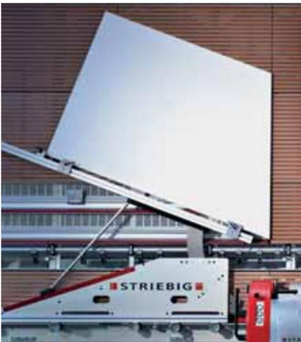
Das Winkelschnittgerät WSG kann links und rechts neben jeder vertikalen Schnittstelle eingesetzt werden. Es ist einfach und schnell montiert. Einsatzbereich: Platten bis 42mm Stärke, exakte Winkel und Gehrungen von 0° - 46°.
