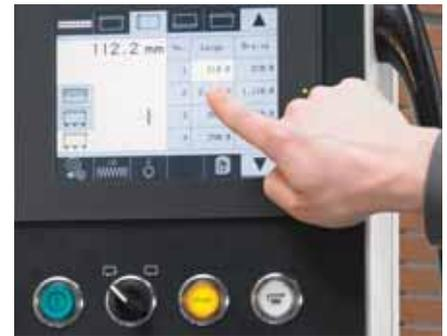
Masse eintippen, fertig. Das Elektronische Positioniersystem EPS ist vollständig in das Touch-Screen Panel integriert. Es erlaubt die einfache und auf den 1/10mm genaue Positionierung der horizontalen und der vertikalen Schnittachse.
