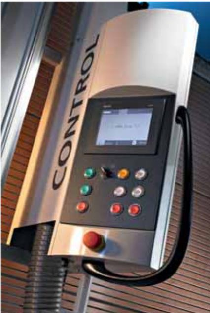
Bedienführung und Fehlererkennung sind mehrsprachig. Selbsterklärende Symbole führen den Benutzer durch das Menü. Es werden immer nur die Funktionen angezeigt, die mit der Säge möglich sind. Fehlbedienungen sind damit weitestgehend ausgeschlossen. Und sollte doch einmal etwas falsch gemacht werden, die Bedienführung hilft Ihnen sicher weiter.
