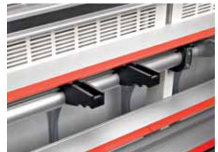
„High-End“-Raster aus faserverstärktem Kunststoff-Material bieten bei besonders empfindlichen Kantenmaterialien und Postforming-Kanten speziellen Schutz.
