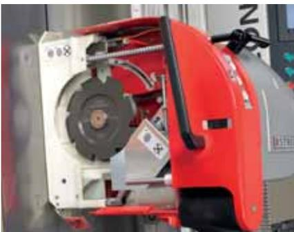
Bei vielen Aufträgen sind Nut- oder Fräsarbeiten notwendig. Diese können auf einer CONTROL ohne Probleme ausgeführt werden. Sie können Holzwerkstoffe und Verbundplatten fräsen und nuten.
