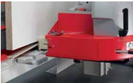
Platten bis zu 5300mm Länge und einer Höhe von 2185mm werden mit dem 4SB-System automatisch unten besäumt. Schwere körperliche Arbeit entfällt.
