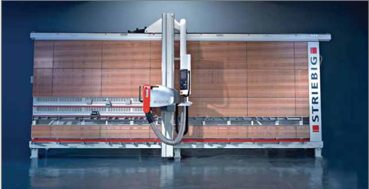
Abb. 1: Dank des hohen Automatisierungsgrades beim Sägeablauf und ihren Ausstattungsoptionen ist die neue CONTROL das vertikale Aufteilzentrum der Premium-Klasse. Der gesamte Plattenzuschnitt läuft vollautomatisch ab. Handarbeit ist vorbei.
