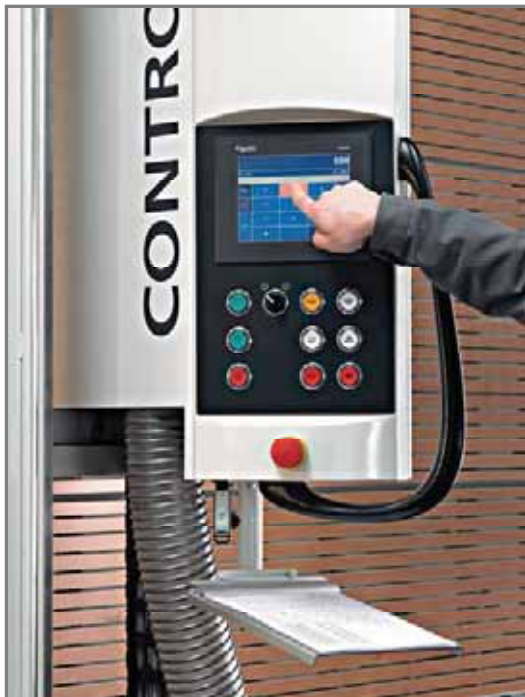
Abb. 2: „Touch&saw“ – die Berührung mit der Fingerspitze reicht aus, um alle Funktionen der neuen CONTROL oder EVOLUTION zu bedienen. Mehrsprachige Bedienerführung und Fehlererkennung ermöglichen eine spielend einfache Bedienung.
