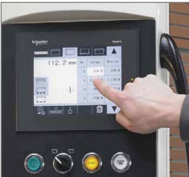
Abb. 6: Eintippen und fertig. Das Elektronische-Positioniersystem EPS der neuen CONTROL erlaubt die einfache und auf den 1/10mm genaue Positionierung beider Schnittachsen.
