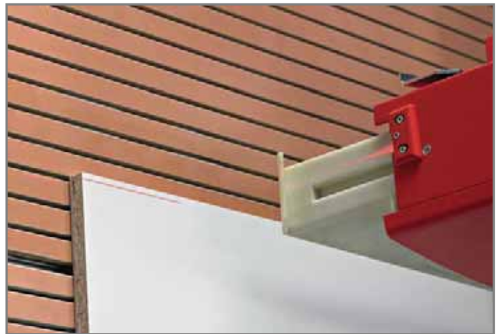
Abb. 3: Serienmässig bei den neuen Sägen CONTROL und EVOLUTION: die Laser gestützte Anzeige des horizontalen Schnittes für einen noch höheren Bedienungskomfort .
