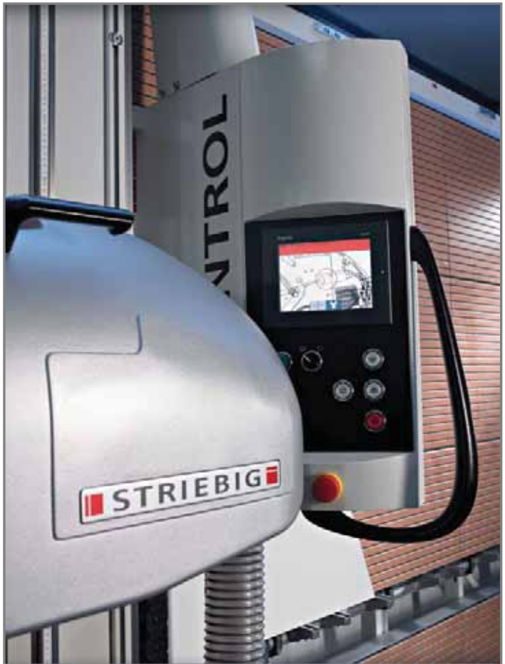
Abb. 5: Mit dem Touch-Screen Panel der neuen CONTROL oder EVOLUTION hat der Bediener jederzeit Zugriff auf alle Betriebsdaten der Sägen. Wartungs- und Fehlermeldungen werden optisch unterstützt. Einfacher kann mit einer Säge nicht kommuniziert werden.
