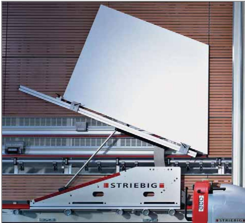
Fig. 7 : Sur la scie à panneaux verticale, les coupes on onglets précises sont un jeu d'enfant avec le dispositif pour coupes d'angle WSG. Le WSG est simplement installé à gauche et à droite du point de coupe vertical respectif.
