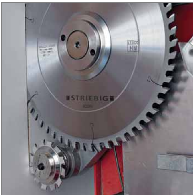
Fig. 8 : Economique en temps, en frais et en outils – le groupe de lame d'inciseur VSA prolonge considérablement la durée de vie d'une lame de scie principale.
