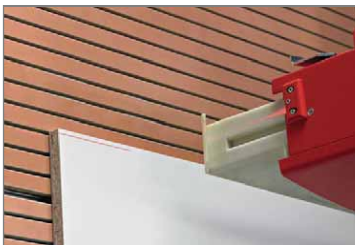
Fig. 3 : De série sur les nouvelles scies CONTROL et EVOLUTION : l'affichage par laser de la coupe horizontale assure un confort de commande encore meilleur.
