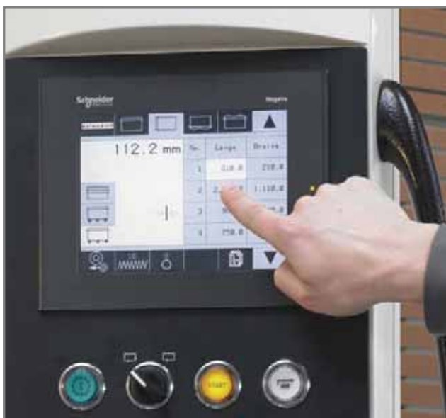
Fig. 6 : Saisir et terminé ! Le système de positionnement électronique EPS de la nouvelle CONTROL permet de positionner facilement les deux axes de découpe avec une précision de 1/10 mm.
