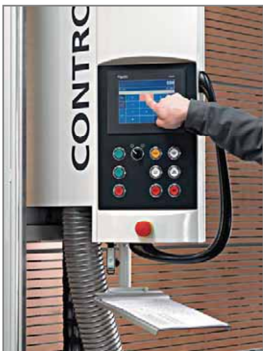
Fig. 2 : « Touch&saw » – un doigt suffit pour piloter l'ensemble des fonctions des nouvelles CONTROL ou EVOLUTION. Le guidage d'utilisateur et la détection des défaillances en plusieurs langues facilitent la commande au maximum.
