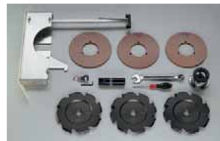
Dispositif de rainurage pour panneaux composites
