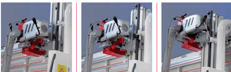
Le dispositif de plongée (crochet de saisie mécanique) facilite la plongée sûre du groupe de découpe dans la partie haute du panneau.
