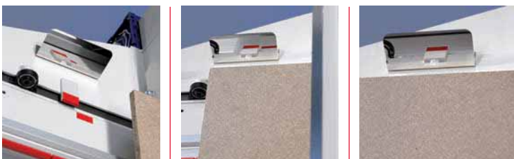
Le miroir sur la traverse de découpe facilite l'orientation lors de la détermination du point d'intersection vertical (important pour les formats de panneaux de grandes taille et débordants).
