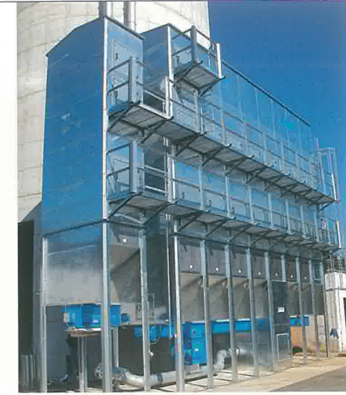
Zwischenfilter für bis zu 200 000 m 3 /h
