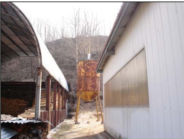
Unsere Ausgangslage: Ein Zyklon mit „Entsorgungsvorrichtung“ für Traktoren.
