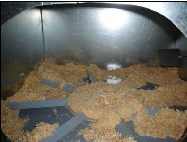
Rundaustragung der Brikettierpresse mit Drehflügelsonde zur Materialbewirtschaftung.
