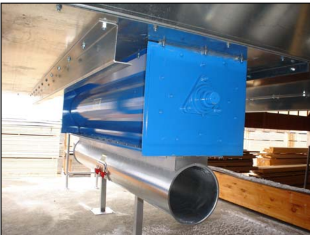
Zellenradschleuse zur Abdichtung zwischen Filteranlage und Ringtransportanlage.
