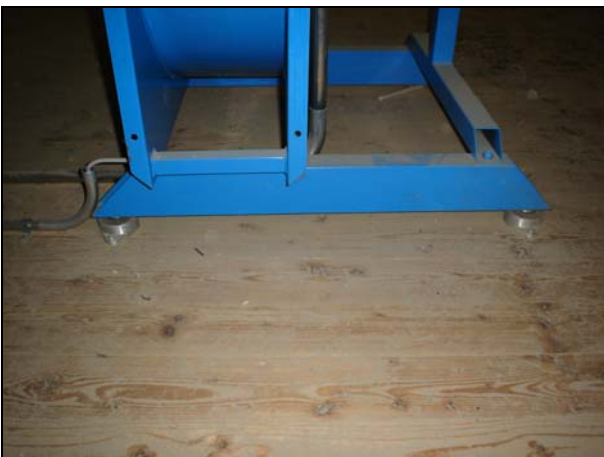
Schwingungsdämpfer für einen vibrationsarmen Betrieb.
