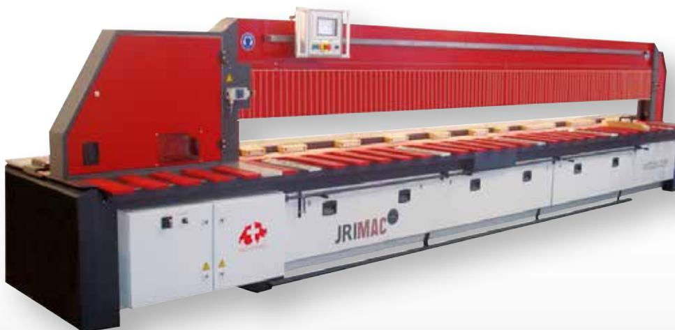
Travail flexible et rationalisé grâce à la commande mobile sur toute la longueur de la machine
