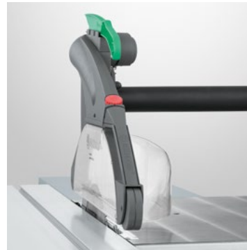
Die optionale große Absaughaube (PSV) sorgt für noch mehr Arbeitssicherheit und ein besseres Handling bei Winkelschnitten. Die Haube lässt sich auf die jeweilige Materialstärke stufenlos und selbsthemmend einstellen. Im Lieferumfang sind eine schmale Haube für 90°-Schnitte, und eine breite Haube für Gehrungsschnitte enthalten.
