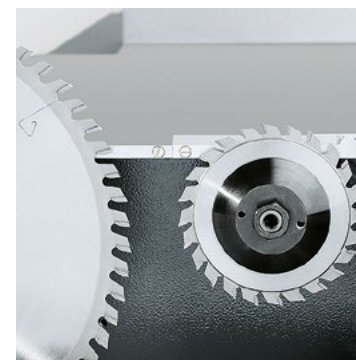
Vorritzer: Separater Vorritzermotor mit 0,37 kW und Ein/Aus-Schalter.
