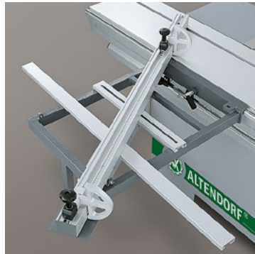
Winkel-Gehrungsanschlag: Für präzises Schneiden von Winkeln und Gehrungen in einer Funktion. Ablängbereich: 105–2600 mm. Schwenkwinkel stufenlos um 49° verstellbar.
