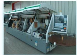
Die einzigartige Kantenfinish-Technologie mit abrasiver Polierwirkung als Nachrüstatz zu bestehenden Kantenanleimmaschinen ermöglicht ein praktisch nach-putzfreies Ergebnis.
