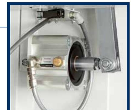
Dispositif automatique pour le centrage du tapis pour une plus grande durée de vie de la bande de transport.
