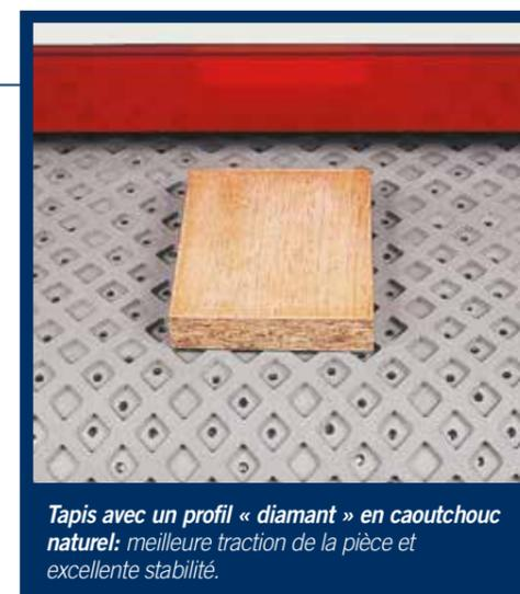
Tapis avec un profil « diamant » en caoutchouc naturel: meilleure traction de la pièce et excellente stabilité.
