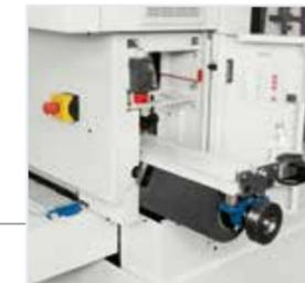
**Groupe de brosses interchangeable** en sortie du plan de travail pour une haute flexibilité d'usinage.
