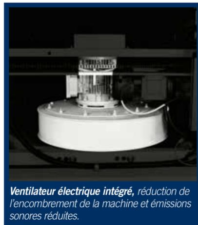
*Ventilateur électrique intégré, réduction de l'encombrement de la machine et émissions sonores réduites.*
