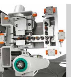
Das Arbeitsaggregat ist komplett ausgestattet: mit Bohrkopf für vertikal und horizontal verlaufende Bohrungen, Sägeblatt für die Rückwandnut entlang der X Achse und Elektrospindel für Fräsbearbeitungen mit 5,5 kW und bis zu 18000 U/min.
