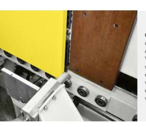
Große Anpassungsfähigkeit: durch den programmierbaren Anschlag können auch Werkstücke verarbeitet werden die schon mit eingesteckten Dübeln versehen sind oder an denen Fräsungen schon vorgenommen wurde.
