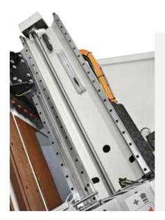
Höchste Präzision und Verfahrgeschwindigkeit, alle Arbeitsaggregate werden von Brushless Motoren angetrieben und gleiten auf Prismenführungen mit Gleitlagern und Kugelumlaufspindeln. Extrem präzise Bauteile garantieren für das exakte Ausführen der Bewegungen in X, Y und Z.
