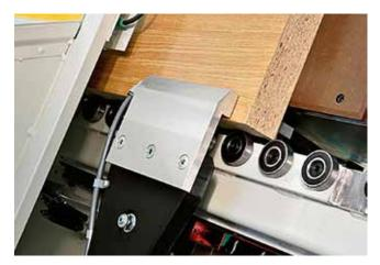
Allergrößte Stabilität des Werkstücks und gehobene Verarbeitungsqualität: dank der beweglichen Zange mit schwebender Öffnung die keinerlei Einstellungen braucht; der kratzfeste Bakelittisch sorgt für eine gehobene Verarbeitungsqualität auch für Platten mit empfindlichen Oberflächen geeignet. Keinerlei Ungenauigkeiten: die vorgesehenen Druckvorkehrungen sorgen dafür auch beim horizontalen Bohren.
