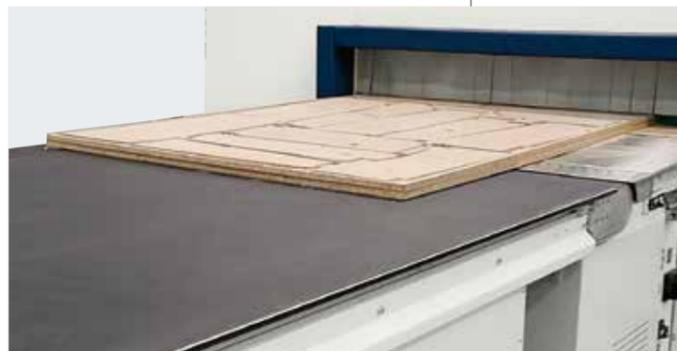
**Maximale Produktivität** mit der **Abschiebevorrichtung**, die die bearbeiteten Werkstücke auf das Abladeband befördert und gleichzeitig den Arbeitstisch säubert, während die neue zu bearbeitende Platte geladen wird.
