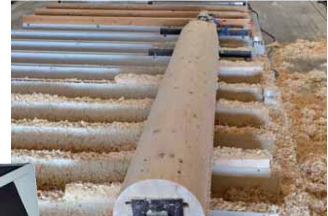
CNC-gesteuertes Bearbeitungszentrum „Area“. Für Wandelemente und geschwungene Leimbinder. Diese Maschine hat ein in der Länge individuell anpassbares Arbeitsfeld und kann Werkstücke bis 3,20 oder 4,50 m in der Y-Achse, bis zu 50,00 m in der X-Achse (modular) sowie 360 mm in Z-Richtung bearbeiten
