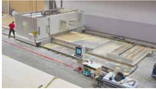
CNC-gesteuerte Abbundanlage „Oikos“. Das mit nur einem einzigen Aggregat sowie mit sieben Bearbeitungsachsen die komplette Bearbeitung eines Balkens für Rahmenkonstruktionen in einem Arbeitsgang und ohne Umspannen übernimmt. Das heißt, an allen sechs Seiten plus weiterem 360°-Bewegungsablauf drum herum. Vollautomatische Beschickung und Entnahmemöglichkeit mit Stapler oder Kran
