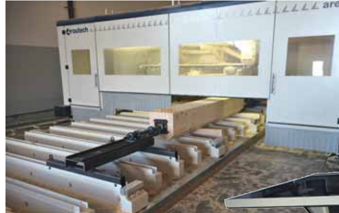
CNC-gesteuerte Abbundanlage „Oikos“. Das mit nur einem einzigen Aggregat sowie mit sieben Bearbeitungsachsen die komplette Bearbeitung eines Balkens für Rahmenkonstruktionen in einem Arbeitsgang und ohne Umspannen übernimmt. Das heißt, an allen sechs Seiten plus weiterem 360°-Bewegungsablauf drum herum. Vollautomatische Beschickung und Entnahmemöglichkeit mit Stapler oder Kran
