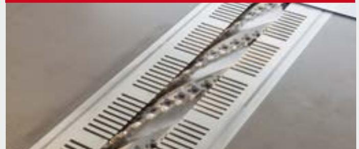
6 spiralförmige Messerreihen und HM-Wendemessern, ziehender Schnitt, hohe Lärmreduzierung, lange Standzeiten, kürzere Späne.
