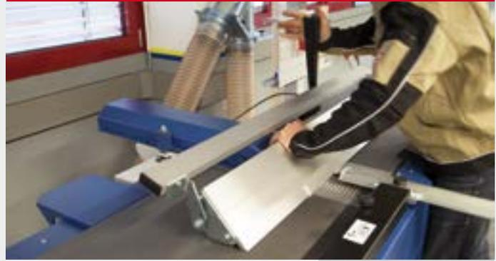
Durch den zentralen Bedienhebel kann der Abrichtanschlag in der Tiefe und im Schwenkbereich von 90 - 45° verstellt werden.
