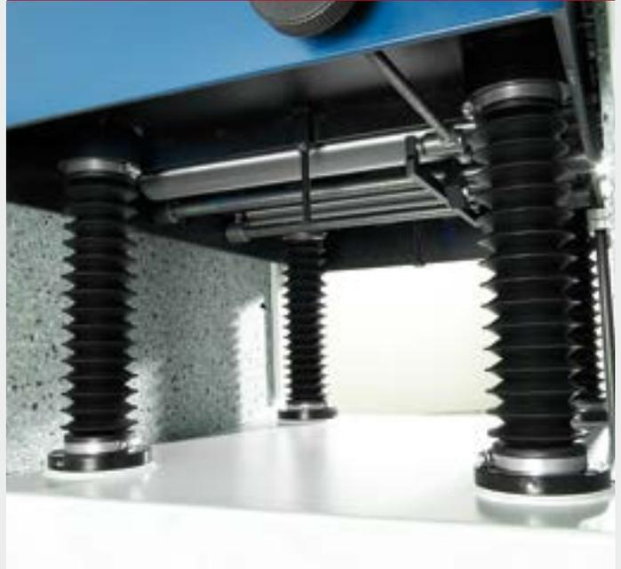
Mit 4 Trapezspindeln, parallel geführt und dadurch kippsicher, für ein optimales Hobelbild.
