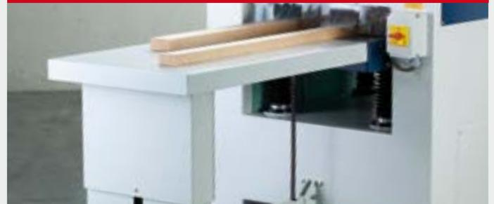
Mit automatischer Höhenverstellung, gegen das Abkippen der Werkstücke Größe 1000 x 630 mm
