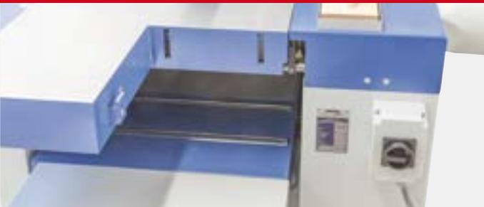
Fördert Kurzteile ab 320 mm Länge aus der Maschine
