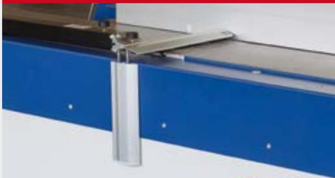
Mit zweiteiliger Abdeckung, stufenlos in der Höhe und Tiefe verstellbar.
