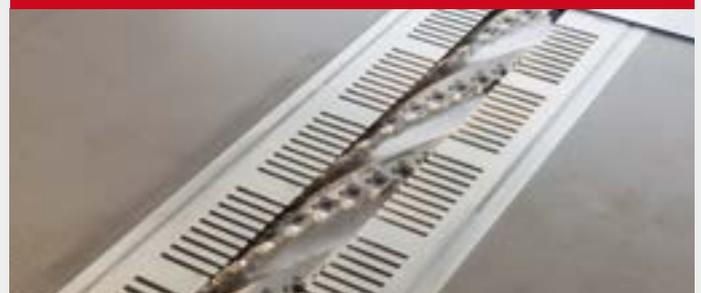
Mit 6 spiralförmigen Messerreihen und HM-Wendemessern, ziehender Schnitt, Lärmreduzierung, kürzere Späne.
