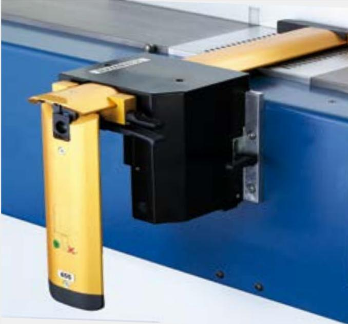
Zweiteilig mit abklappbarer Abdeckung, mit gefedertem Anpressdruck.
