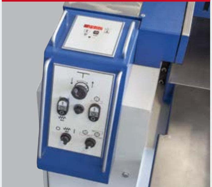
Positioniersteuerung easy drive für einfaches und präzises Einstellen der Hobelhöhe von 3 bis 250 mm
