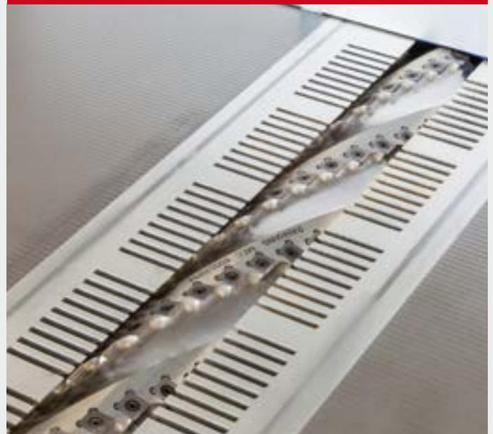
Mit 6 spiralförmigen Messerreihen und HM-Wendemessern, ziehender Schnitt, enorme Lärmreduzierung, lange Standzeiten, kürzere Späne.
