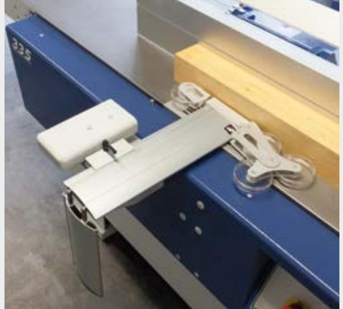
Zweiteilig mit abklappbarer Abdeckung, mit gefedertem Anpressdruck.
