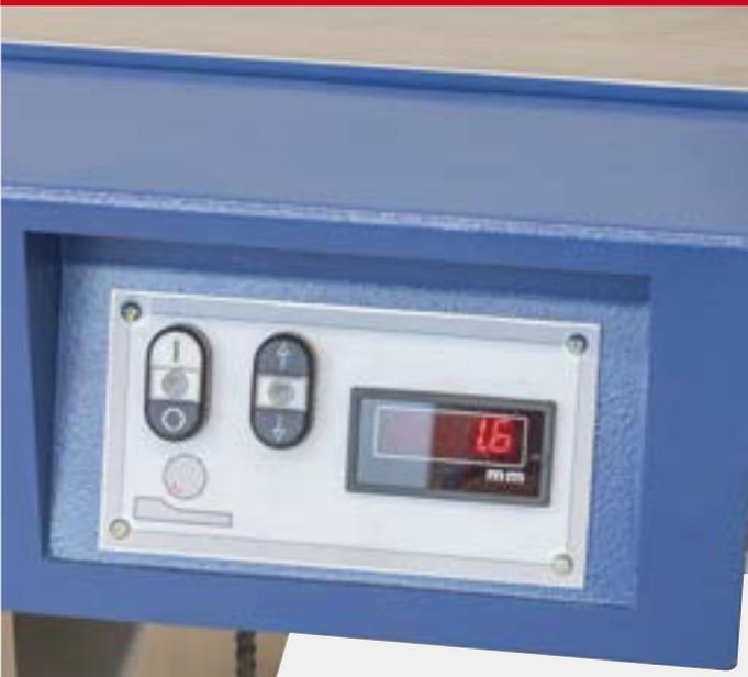
Elektrische Verstellung über Tiptaster, mit LED-Anzeige, Genauigkeit 0,1 mm
