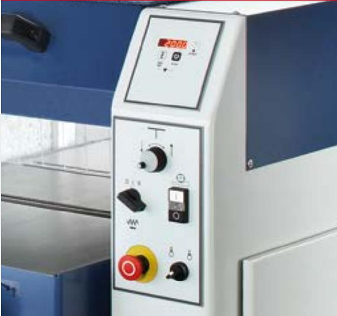
Einfaches und präzises Einstellen der Hobelhöhe von 3 - 300 mm mit Umschaltfunktion Hobelhöhe/Spanabnahme
