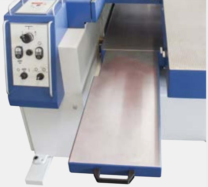
Im Dickenhobel-Modus befindet sich das Tischelement des Abrichttisches in der unteren Position als Einlaufverlängerung des Dickentisches.
