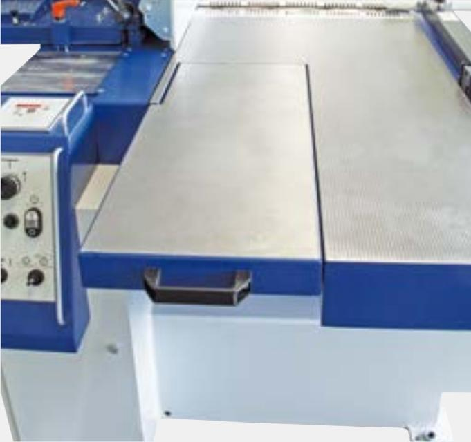
Für eine vollflächige Auflage beim Abrichthobeln größer als 315 mm bis 630 mm Breite wird das Tischelement im Abrichttisch eingesetzt.
