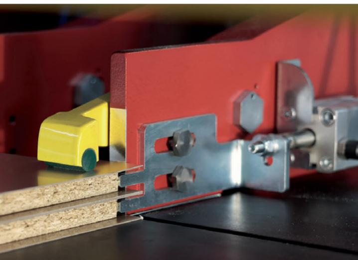
Automatisches Reinigungssystem für Führungswellen des Sägeaggregates – wartungs- und verschleißfreies Führungssystem
