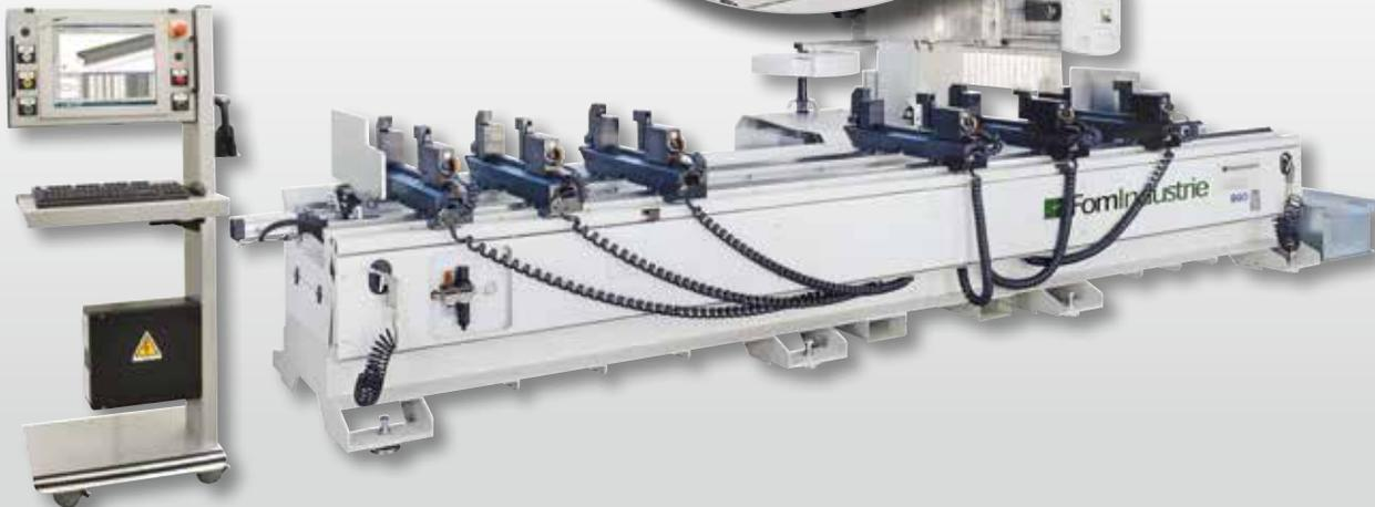
**Pour l'usinage entièrement automatique de différents profilés en aluminium, en PVC et en acier.**
