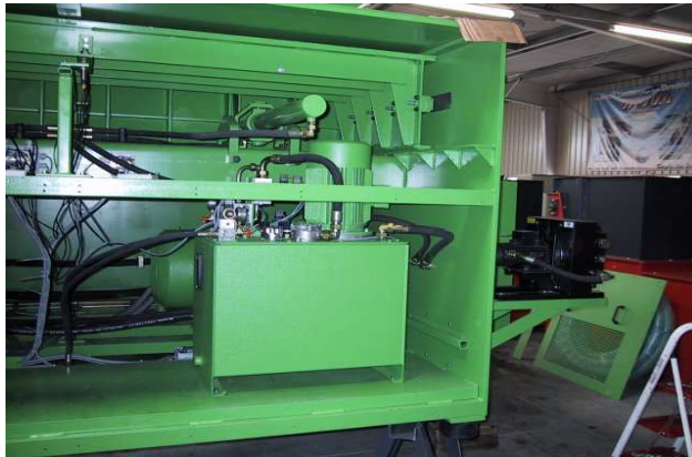
WEIMA mit stoss- und staubgeschützter Hydraulik
