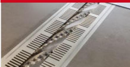
mit 6 spiralförmigen Messerreihen und HM-Wendemessern für ziehenden Schnitt und enorme Lärmreduzierung
