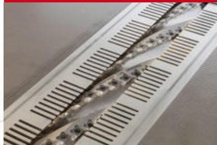
mit 6 spiralförmigen Messerreihen und HM-Wendemessern für ziehenden Schnitt und enorme Lärmreduzierung
