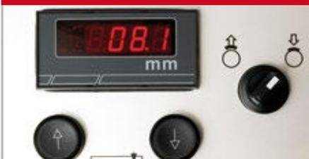
mit Druckstasten zur elektrischen Tischverstellung
