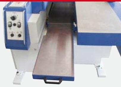
im Dickenmodus befindet sich das Tischelement des Abrichttisches in der unteren Position als Einlaufverlängerung des Dickentisches
