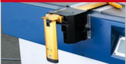
mit zweiteiliger und abklappbarer Abdeckung mit gefedertem Anpressdruck
