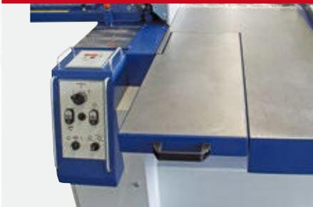
für eine vollflächige Auflage beim Abrichthobeln größer als 315 mm bis 630 mm Breite wird das Tischelement im Abrichttisch eingesetzt
