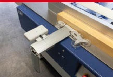
Schutzvorrichtung mit zweiteiliger und abklappbarer Abdeckung, mit gefedertem Anpressdruck
