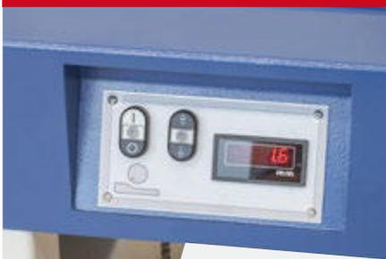
elektrische Verstellung über Tipptaster, mit LED-Anzeige, Genauigkeit 0,1 mm
