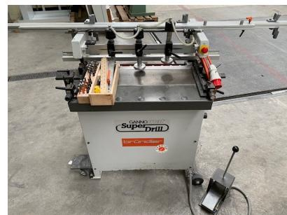
**OCC.2460 Reihenlochbohrmaschine Superdrill Typ 300 Gannomat**
